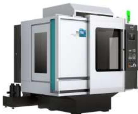
Вертикальные центры MDV используются для обработки сложных корпусных деталей, коробок скоростей в автомобильной промышленности и др. Также это лучший выбор при производстве пресс-форм среднего и малого размеров. Из-за большого крутящего момента на шпинделе станки серии MDV эффективно обрабатывают высокопрочные стали, жаропрочные сплавы, титан и другие труднообрабатываемые материалы.
