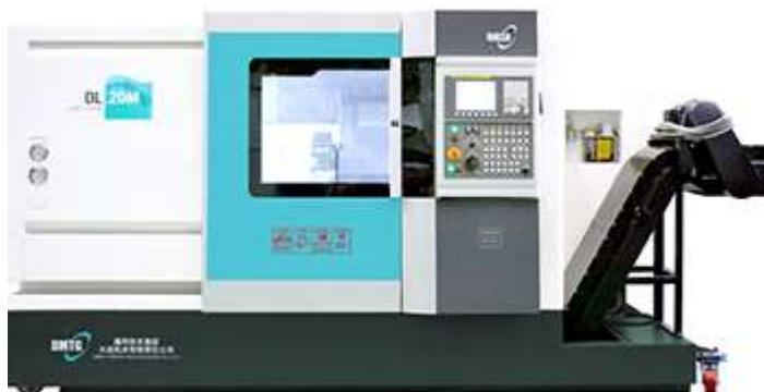
Токарные станки с ЧПУ с наклонной станиной серии DL-M широко используются для обработки деталей валов и дисков в автомобильной, пресс-форме, подшипниковой, нефтяной, угольной промышленности и др. Детали могут автоматически выполнять многопроцессорную токарную обработку, растачивание и сверление после один зажим., расширение, развертывание, нарезание резьбы и другая обработка.
