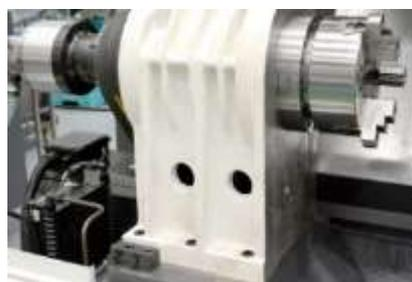
Токарный станок с ЧПУ CLS-20 представляет собой двухосевой токарный станок с ЧПУ полузамкнутого контура. Станина основной машины изготовлена из цельного литья, а направляющие станины наклонены под углом 45° и обладают высокой жесткостью. Система управления использует FANUC Oi-TF, GSK и другие системы, а также сервопривод переменного тока, который может выполнять различную токарную обработку деталей вала в пределах  $\varnothing 260$  мм и дисковых деталей в пределах  $\varnothing 300$  мм.
