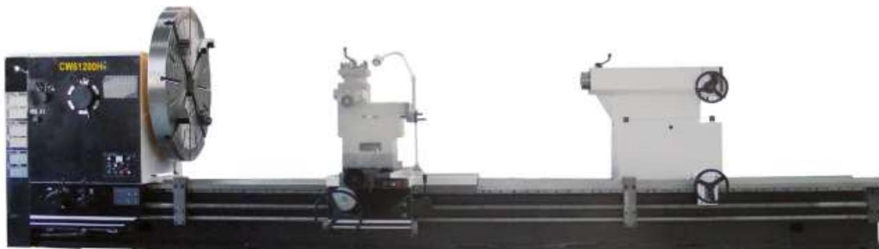
Тяжелые токарные станки CW-N предназначены для черновой и получистовой обработки крупногабаритных деталей из чугуна, стали, цветных металлов и сплавов. На станках можно производить обработку внутренних и наружных цилиндрических поверхностей, обработку конических поверхностей, торцевых поверхностей, нарезание метрических, дюймовых, модульных и питчевых резьб, проточку канавок, сверление отверстий и другие операции.
