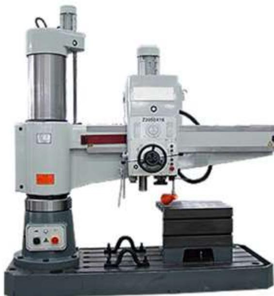
Радиально-сверлильные станки находят широкое применение в промышленности - от ремонтного цеха до крупносерийного производства. На радиально-сверлильных станках можно выполнять сверление, в сплошном материале, рассверливание, зенкерование, развертывание, подрезку торцов (цековка), зенкование, нарезание резьбы метчиками и другие операции, а также при наличии дополнительных приспособлений - фрезерование.
