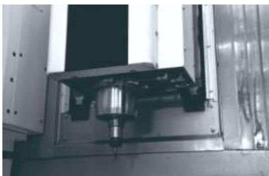
Пятикоординатный вертикальный обрабатывающий центр серии VDWA50 разработан и изготовлен на основе исследований в области высоких технологий, а также с учетом новейших разработок в машиностроении. Станки данной серии широко используются в аэрокосмической, автомобильной, приборостроительной промышленности, а также для изготовления деталей сложных геометрических форм.
