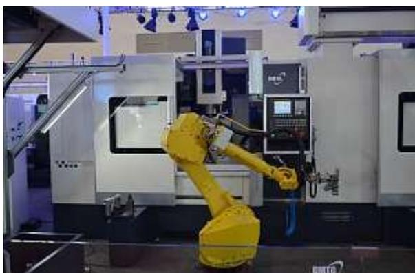
Данная гибкая (легко перестраиваемая) автоматическая линия состоит из трёх вертикальных обрабатывающих центров INGERSOLL–650 вместе с роботом и другими узлами.
