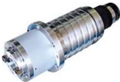
Высокоскоростной прецизионный шпиндель приводится в движение зубчатым ремнем, что существенно снижает передачу шума и тепловыделения. В шпинделе используются угловые шариковые подшипники, обеспечивая стандартную скорость 8000 об/мин. Система охлаждения шпинделя эффективно снижает влияние термической деформации, что позволяет увеличить срок службы. В шпинделе используется IRD система, позволяющая избегать резонанса на высоких скоростях работы.
