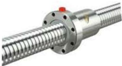
Высокоточные шарико-винтовые пары, обладают хорошими динамическими характеристиками, высокой скоростью срабатывания, низким уровнем шума и трения. Высокоточные шарико-винтовые пары СЗ, предварительно натянутые, используются на осях X/Y/Z для точной передачи движения, обладают низким уровнем шума и не зависят от температурных деформаций.
