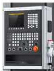
Станки стандартно оснащаются системой ЧПУ FANUC 0i-MF, но могут быть установлены и другие системы управления такие как Siemens, Heidenhain и др. В системе управления могут быть встроены функции для работы четвертой оси в соответствии с требованиями заказчика.
