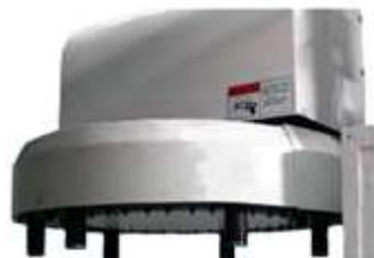
Надежный автоматический манипулятор для смены инструмента работает быстро и плавно в двух направлениях (пневматическое и электрическое управление) по ближайшему маршруту. В барабанном магазине можно хранить до 20 (опция 24) инструментов.
